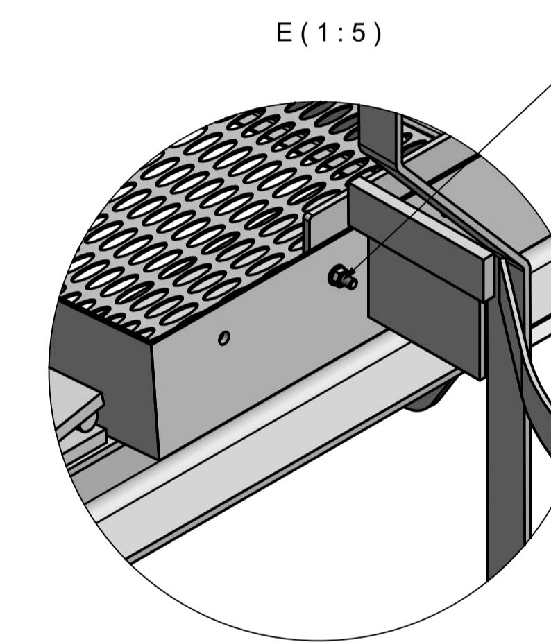
2 Stk Maschinenschrauben 8.8 M20x70 mit Polystoppmutter
